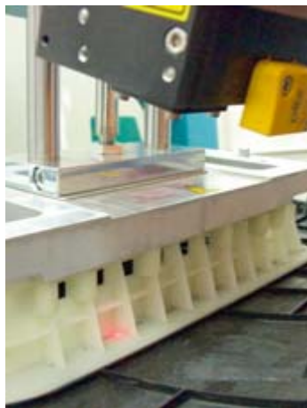
Schweißen des Schusskanals für den Airbag per Laser – die Technologie schließt sich nahtlos an das Perforieren des Armaturenbretts an.
